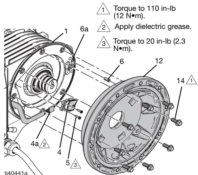
**FIG. 12: Motor Sensor**
